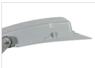
60077 - LEDMASTER ONE JUST Visiera antiabbagliamento per versione asimmetrica (15°), in alluminio verniciato di colore silver. Aluminium anti-glare louvre for asymmetric version (15°), coated in silver colour.
